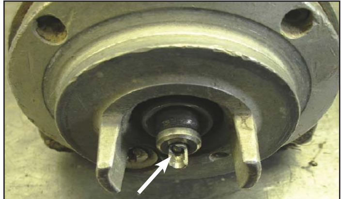
La CCSN a reçu deux rapports d'incidents impliquant l'assemblage de source dans les appareils à rayonnement MDS Nordion Gammamat TSI 5/1. Dans chacun de ces incidents, le connecteur femelle sur l'assemblage de source s'est cassé en deux.
