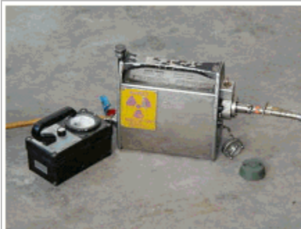
Image 5 : Appareil (caméra) de gammagraphie industrielle contenant une source scellée radioactive
