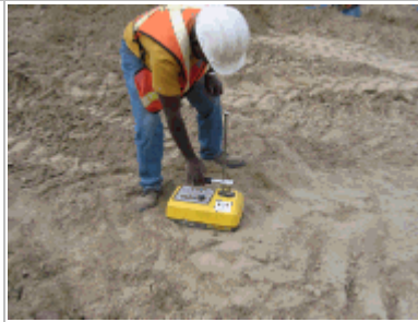
Image 10 : Jauge portative en cours d'utilisation
