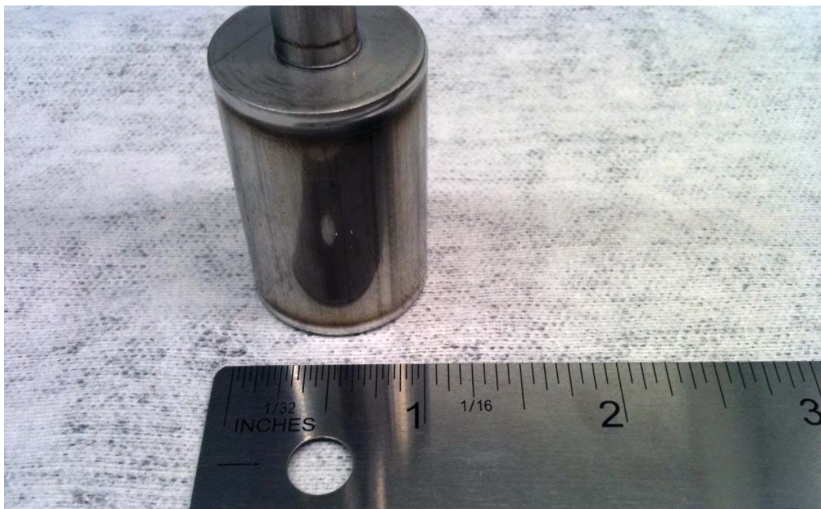
Voici un exemple de lit d'adsorption au tritium. Celui-ci contient le tritium utilisé lors de la fabrication de sources lumineuses au tritium gazeux.
